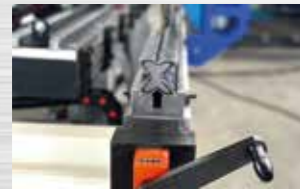
Centinatura con tavola tipo WILA con sistema manuale ad onde contrapposte
