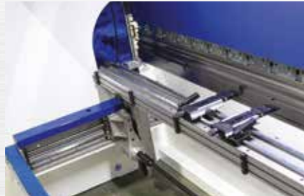
Meccanica 2 assi con servomotori 2 assi X+ R
