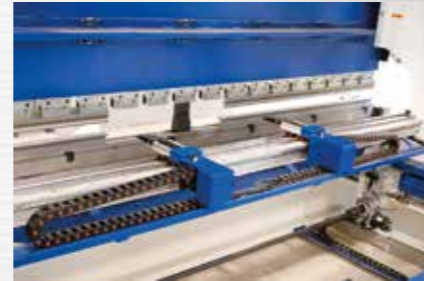
Meccanica 4 assi con servomotori 4 assi X+ R +Z1+Z2
