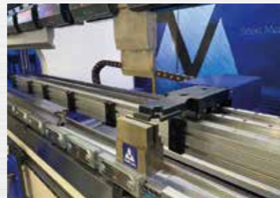
Meccanica 4 assi con servomotori 4 assi X+ R +Z1+Z2
