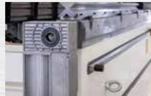
Centinatura con tavola tipo WILA con sistema motorizzato CNC ad onde contrapposte
